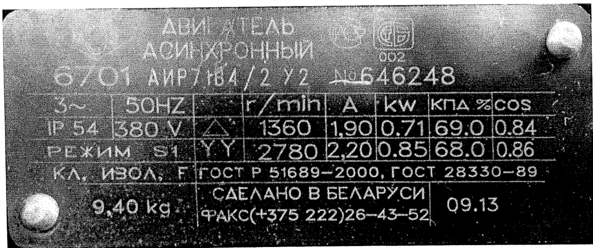
(сл. 02.) Натписна плочица мотора „АИР71В4/2“. Мотор се везује само у спој троугао (1360 о/мин)
